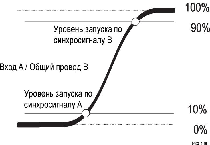
Прибор вычисляет и устанавливает уровни синхронизации. Время нарастания и спада может измеряться как на входе А, так и на входе В.
